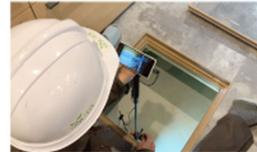
建築業界において日々行われる確認業務のうち、時間がかかる上に体力的な負担が大きいとされる天井点検口や床下点検口、ユニットバス点検口などの内部の確認では、無理な体勢での業務や脚立に上ったの作業が発生し、安全面における課題を抱えていました。人手不足の深刻化した建設業界では、これらの確認業務の外注も困難で、重要な確認業務に従事する人員の高齢化も懸念されています。この度、リオールとザクティの連携によって新たに登場した「建築用 床下天井裏 検査キット」は、リオールが長年のサービス提供を通じて蓄積した現場の声と、ザクティが培った映像技術を活かし、現場の「こまった」に応えるDXパッケージです。「建築用 床下天井裏 検査キット」の活用により、作業員の身体的な負担を軽減し、業務効率化を実現します。
